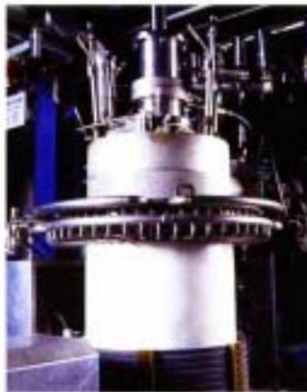
上、右：冷坩埚熔炉的内部和外部 最右：等离子体焰炬熔炉的外观
